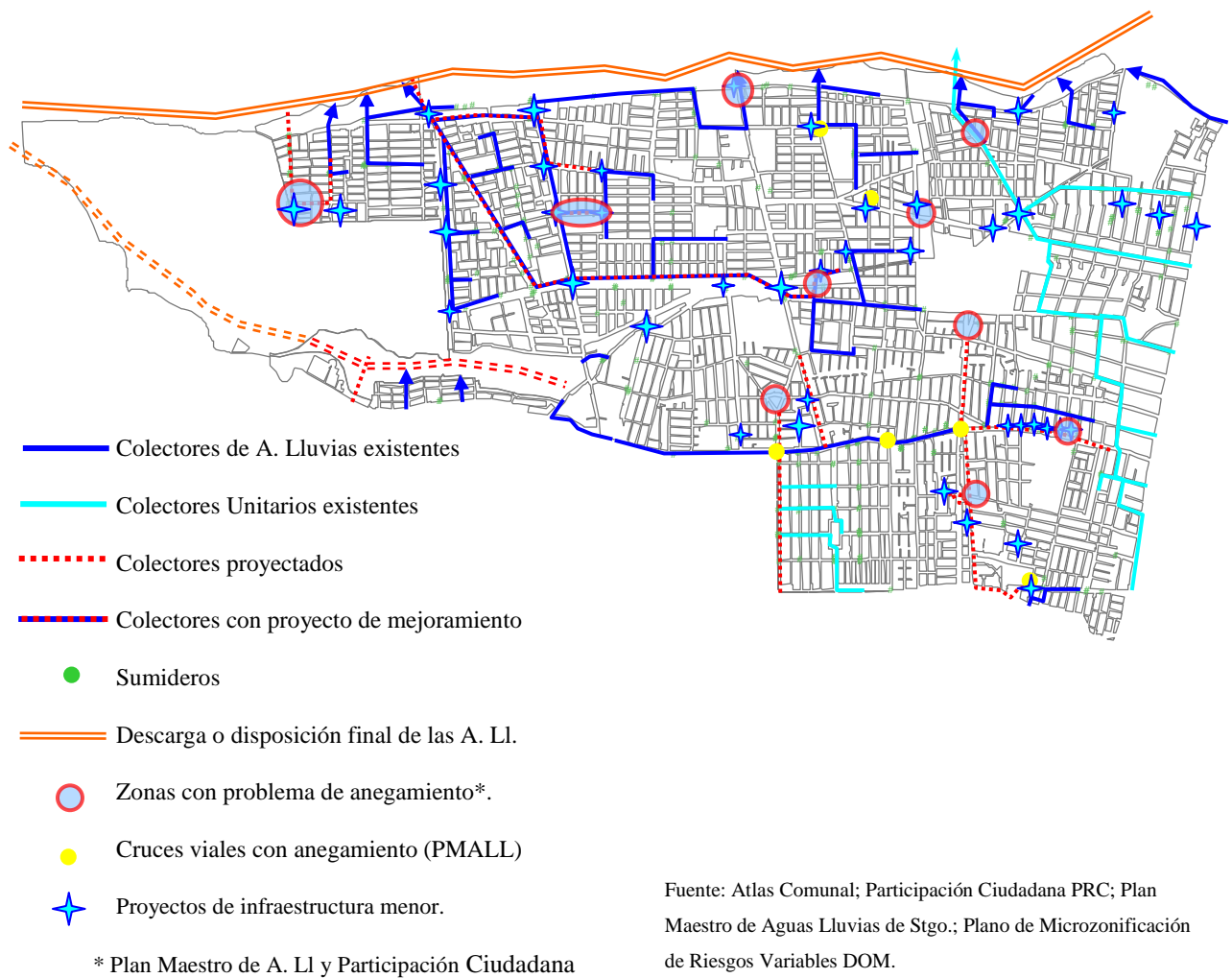
Figura 3: Infraestructura existente y proyectada
